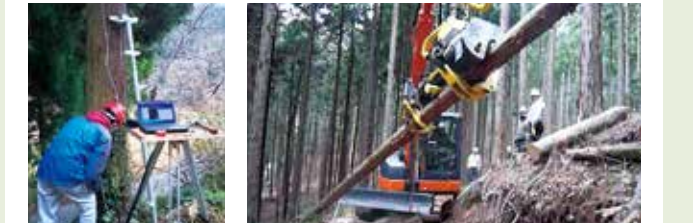
▲立木のヤング率の測定 | ▲小型ストローク式ハーベスタの生産性調査
